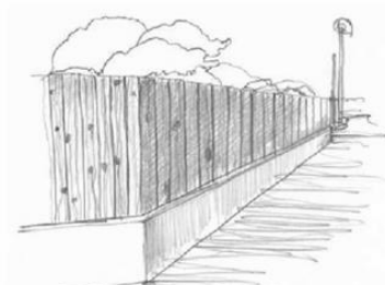
Clôture en palissade de bois sur muret en maçonnerie
