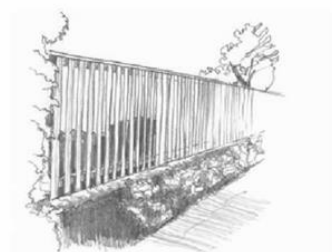
Clôture en planches de bois à claire-voie sur muret en maçonnerie
