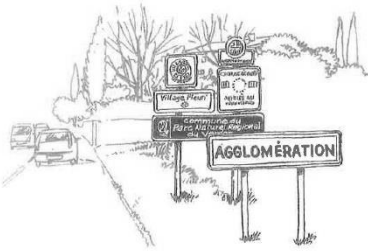
Possibilité de regroupement après le panneau d'entrée d'agglomération.
